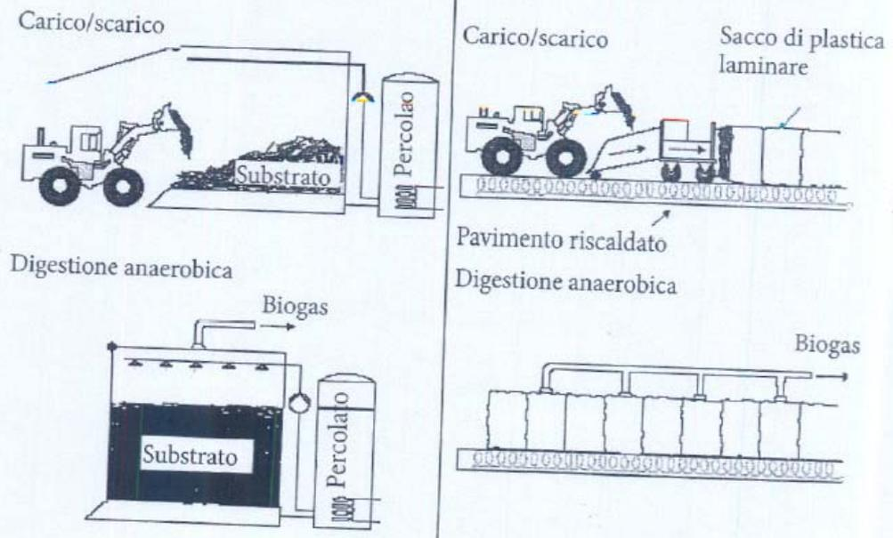
**Figura 2** - Schema di copertura di vasca anaerobica con riscaldamento
